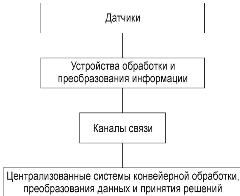
Рисунок 4.13 – Структурная схема получения-обработки информации в ПТК с конвейерной обработкой данных на верхнем уровне
